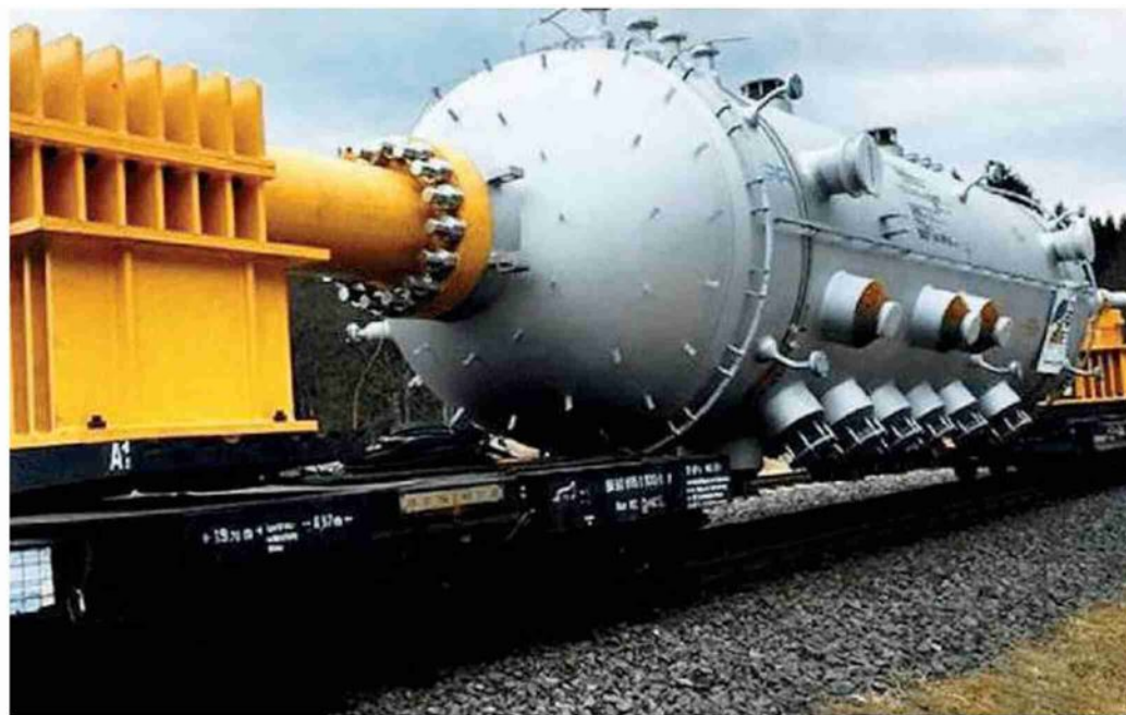
Small Modular Reactor. Un mini reattore Smr trasportato su rotaia
